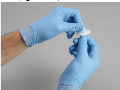
Figura 8 - Ruotare in senso antiorario le metà della trappola
