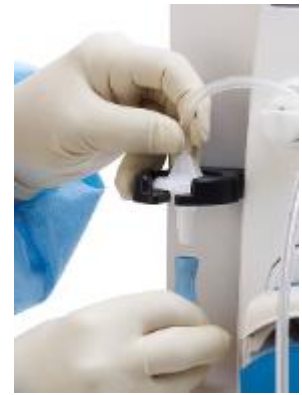
Figura 23 Conectar el tubo de vacío
