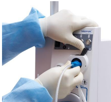
Figur 16 Låsning af katetergrænsefladens låsehåndtag
