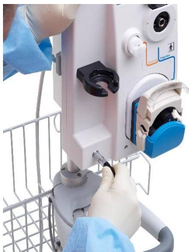
Obrázek 12 Připojení nožního ovladače
