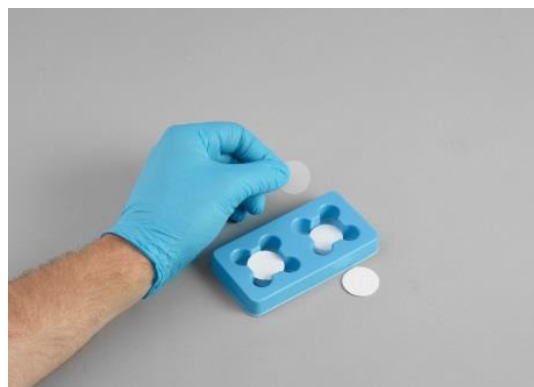
Figura 7 Sustitución del filtro
