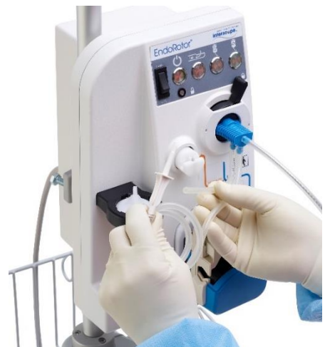
Figura 17 Tubo de ligação do Instrumento de Captura de Amostras
