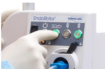
Figur 18 Knapp for frigjøring av vakuumstyring
