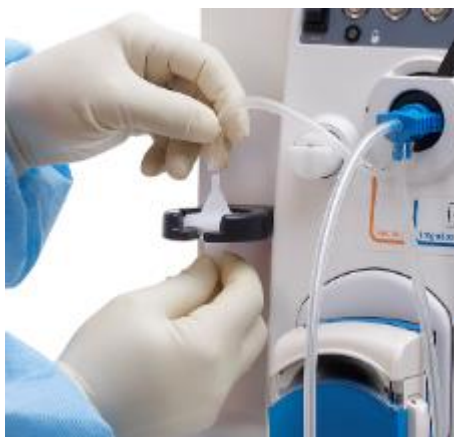
Figur 22 Tilslutning af vakuumslange
