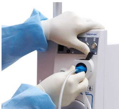
Afbeelding 16 De vergrendelingshendel van de katheterinterface vergrendelen
