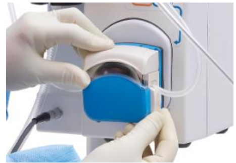
Abbildung 26: Schließen der Pumpe
