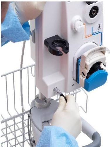
Figura 12 Conexión del control de pedales
