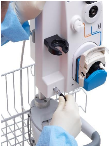
Figura 12 - Collegamento del comando a pedale
