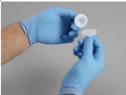
Obrázek 9 Oddělení polovin lapače
