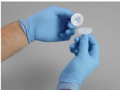
Figura 9 - Separare le metà della trappola
