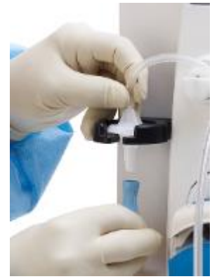
Figura 23 Ligação do Tubo de Vácuo
