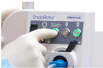
Afbeelding 18 Ontgrendeling vacuümregeling
