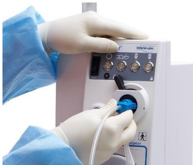
Obrázek 15 Zavedení proximálního pouzdra katétru
