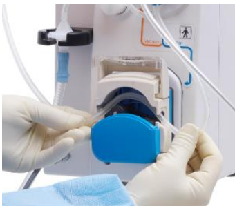
Bild 24 För in slangen
