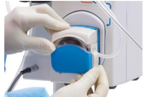
Figure 26 : fermeture de la pompe
