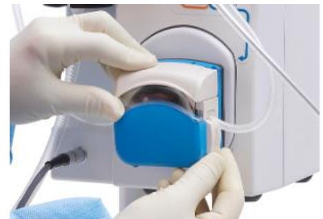
Bild 26 Stäng pumpen
