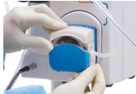
Obrázek 26 Zavření pumpy
