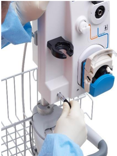
Figure 12 Branchement de la pédale de contrôle
