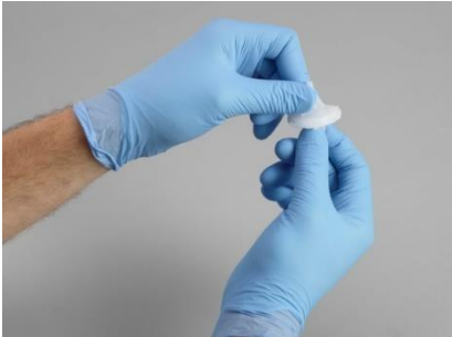
Afbeelding 8 De helften van het opvangmechanisme tegen elkaar in draaien
