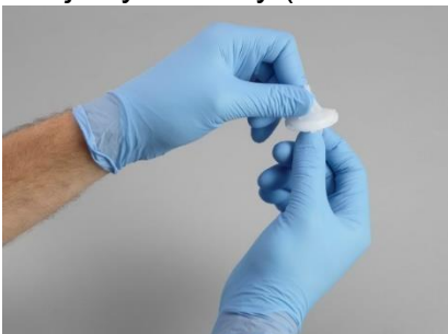
Obrázek 8 Otáčení polovin lapače proti sobě
