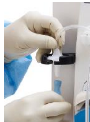
Obrázek 23 Připojení vakuové hadičky
