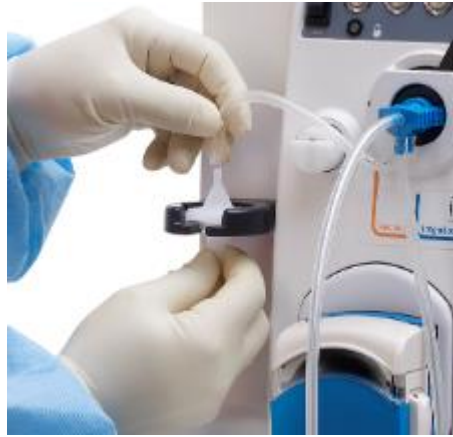
Figura 22 Ligação do Tubo de Vácuo
