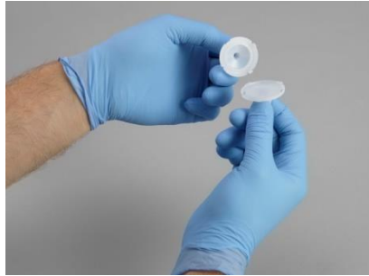
Afbeelding 9 De helften van het opvangmechanisme van elkaar scheiden
