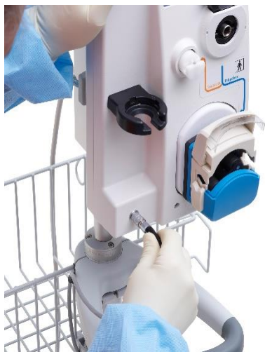
Figur 12 Tilslutning af fodstyreenhed
