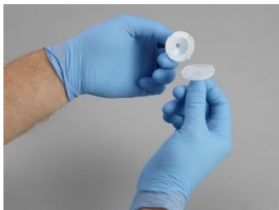
Figur 9 Adskil opsamlerens to halvdele
