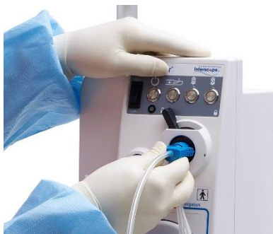
Figura 15 - Inserimento dell'alloggiamento prossimale del catetere
