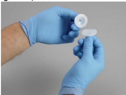
Figur 9 Prøveoppsamlerens halvdel tas fra hverandre
