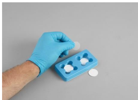
Figure 7 : remplacement du filtre
