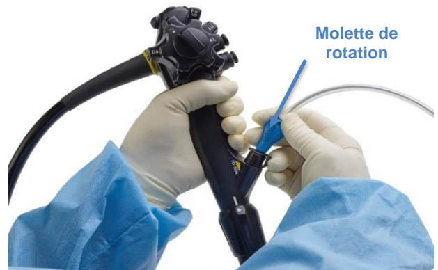
Figure 30 : molette de rotation de l'endoscope en fonctionnement
